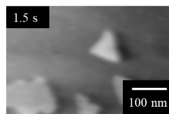
図 4 銅電析の高速 AFM 観察例
